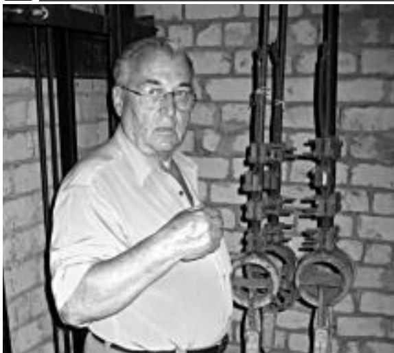
Інженер Центральної енерголабораторії ВАТ «Кривбасзалізрудком» Микола ШИДО демонструє новий причинний пристрій, який входить в комплекс розробленої підйомної установки. Його запропонував Дмитро Колосов замість балансирного причіпного пристрою, який мав різну довжину важелів і неоднаково реагував на зміну навантаження на канат, що викликало вібрацію. Нова конструкція причинного пристрою працює без балансира на пружинних динамометрах під кожен ГТК, що й забезпечує плавність ходу ліфта.
